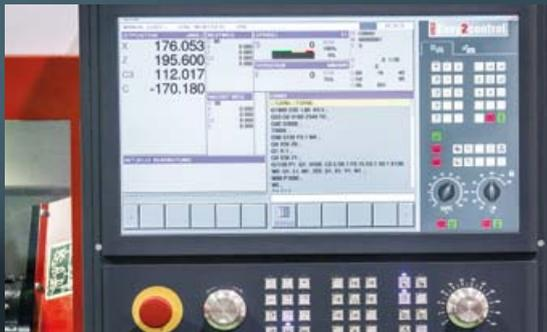
Der Wechsel auf eine andere Steuerung erfolgt durch Aufruf der entsprechenden Software innerhalb einer Minute.
