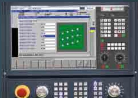
Der Wechsel auf eine andere Steuerung erfolgt durch Aufruf der entsprechenden Software innerhalb einer Minute.
