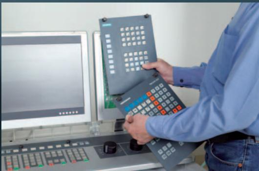
Der Wechsel auf eine andere Steuerung erfolgt durch Aufruf der entsprechenden Software und durch einfachen Austausch des steuerungsspezifischen Moduls innerhalb einer Minute.
