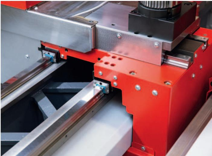
**Linearführungen.** Stabile und gehärtete Linearführung in beiden Achsen.
