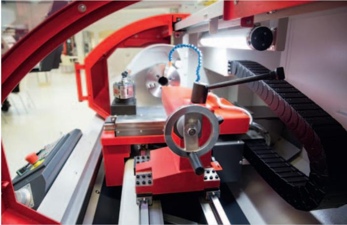
**Arbeitsraum.** Im Automatikbetrieb wird der Arbeitsraum mit 2 verschiebbaren Späneschutztüren verschlossen. Im Handbetrieb kann mit geöffneten Späneschutztüren gearbeitet werden.
