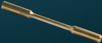
Tensile test (Brass)
