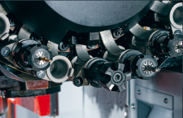
Trommelmagazin mit 20 Werkzeugpositionen
