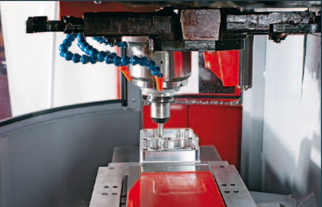
Werkzeugwechsel: Schnellwechsler mit Doppelgreifer und variabler Werkzeugplatzkodierung (random). Mechanische Spindel mit Hochleistungs-Spindelantrieb.
