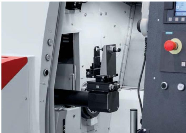
**Integrierter Schwenklader.** Der integrierte Schwenklader greift die Rohteile aus der Zuführung ab und fährt durch eine seitliche Öffnung in den Arbeitsraum der Maschine. Dort wird das Teil in das Spannfutter meist gegen Anschlag positioniert oder auch orientiert in eine Spannvorrichtung geladen.
