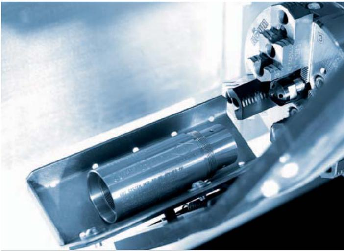
**Gegenspindel und Teilefänger.** Die Gegenspindel inkludiert einen hubüberwachten Teile-Ausstoßer, der mit Kühlmittel durchflutet wird. Er stößt die Teile automatisch in den Teilefänger, der die Teile wiederum aus der Maschine transportiert und in einen Behälter oder auf ein Staubband ablegt.
