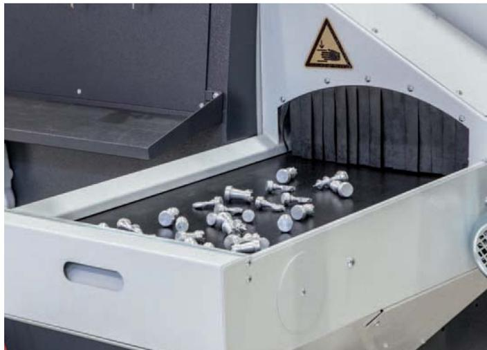
**Fertigteile.** Die Fertigteile werden größtenteils mit dem Teilefänger schonend auf ein Stauband abgelegt.
