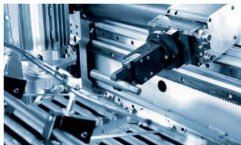
Taktförderband mit Prismenauflagen für unterschiedlich vorgeformte Wellenteile
