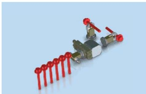
2-Fingergreifer mit 180°-Drehmodul für die Beladung von vertikal zugeführten Rohteilen
