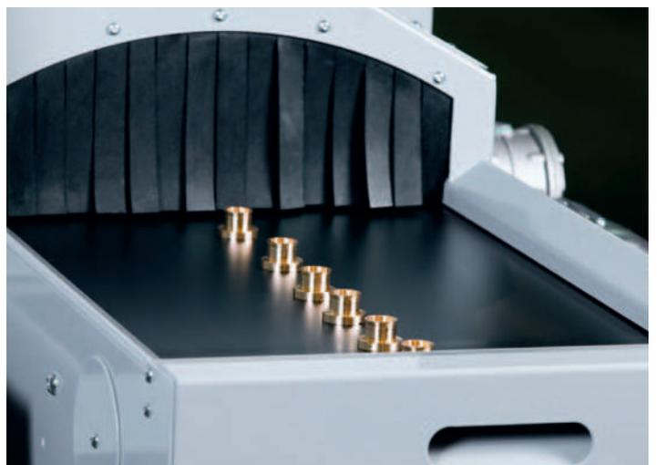
**Fertigteileband.** Mit dem Teilefänger werden die Fertigteile auf ein Staubband abgelegt. Ein Takten des Bandes verhindert, dass die zum Teil sehr komplexen Teile aufeinander fallen.
