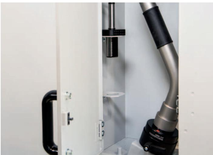
**Messtasterablagenische.** Geschützter Ablagebereich für den Werkzeugmesstaster und die Einstelllehre.
