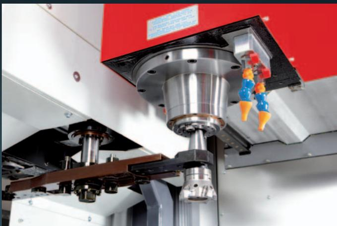
Hochleistungsspindel ISO 40 DIN 69871 / ISO 7388/2 Typ B.
