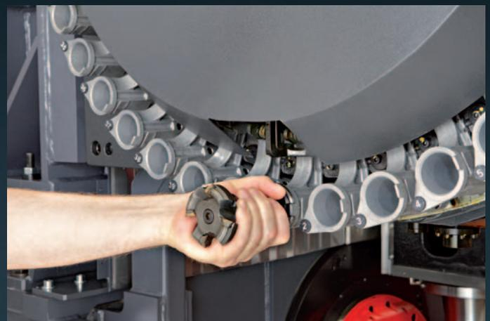
Die Werkzeugtrommel ist mit 30 (optional 40) Werkzeugplätzen ausgestattet. Die Werkzeugverwaltung basiert auf dem Prinzip der variablen Werkzeugplatzkodierung (random), d.h. das Werkzeug wird aus Zeitgründen immer im nächsten freien Magazinplatz abgelegt. Alternativ kann auch eine Festplatzkodierung, z.B. für größere Werkzeuge, angewendet werden.
