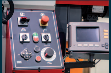
Bedienpult. Das Bedienpult ist mit einer übersichtlichen Tastatur und einer ausschwenkbaren Positionsanzeige für eine einfache Bedienung ausgestattet.
