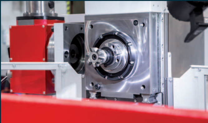
Wechsel auf Horizontalfräsen. Horizontale Frässpindel DIN69871 SK40
