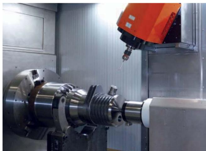
**Werkzeugvermessung.** Die komplette Werkstückvermessung ist in den Prozess integriert und garantiert hohe Genauigkeit sowie Messungen während den Bearbeitungen.
