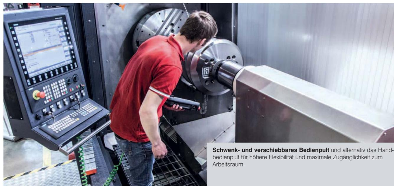
**Schwenk- und verschiebbares Bedienpult** und alternativ das Handbedienpult für höhere Flexibilität und maximale Zugänglichkeit zum Arbeitsraum.
