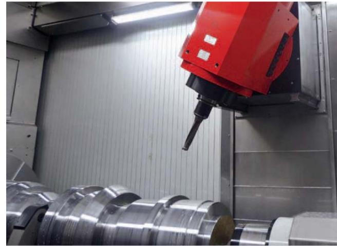
**Frässpindel.** Für stabile, präzise und flexible Bohr- und Fräsoperationen. Bis 80 kW und 630 Nm Drehmoment sowie 10.000 U/min. Sperrluft, HD-Kühlmittel intern bis 40 bar und extern bis 14 bar mit einem 1400 Liter Papierbandfilter serienmäßig (80 bar opt.). Mit der B-Achse kann in jedem beliebigen Winkel gearbeitet werden oder mit indexierter B-Achse im 2,5° Schritt.
