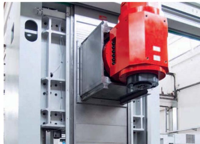
**Fahrständer.** Ist wie bei den Maschinen von EMCO MECOF in einer „Box-in-Box“-Ram-Konstruktion aufgebaut. Damit sind optimale Steifigkeit und Stabilität gewährleistet und eine hohe Genauigkeit bei der Bearbeitung umsetzbar. Die B-Achse ist mit Torque-Motor ausgestattet und in das Ram-Design integriert.
