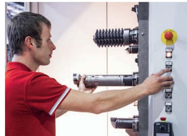
**Ergonomische Beladung** des Werkzeugmagazins mit Werkzeugen bis 25 kg und 600 mm Länge
