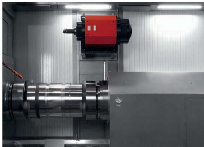
**Leistungsstarke Gegenspindel.** Gegen- und Hauptspindel sind von den technischen Daten und der Konstruktion ident. Das ermöglicht noch komplexere Teile in einer Aufspannung komplett zu bearbeiten. Für den Kunden bedeutet das ein Mehr an Flexibilität, Produktivität und geringere Lagerkosten.
