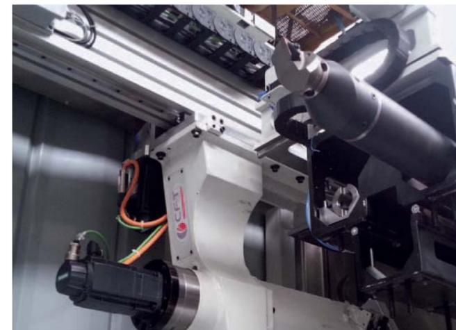
**XL-Magazin.** Mit einem 3-fach Pick-up Magazin ausgestattet, kann es Werkzeuge bis zu einer Länge von 1000 mm fassen.
