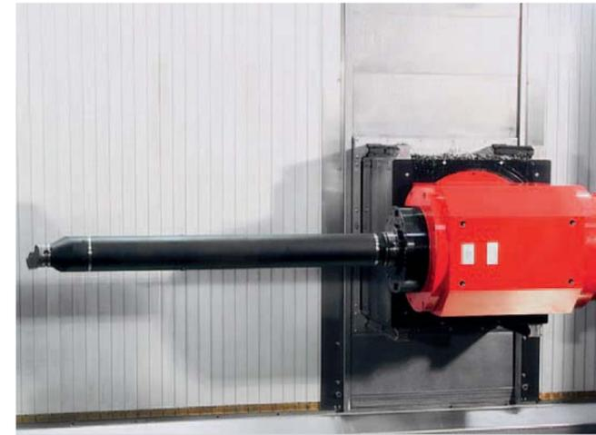
**Drehoperationen.** Außen oder innen sind die Drehoperationen mit der stabilen Frässpindel im 3° Schritt möglich. Optional kann eine schwingungsgedämpfte Bohrstange bis zu einer Länge von 1000 mm und ein 3-fach Pick-up Magazin ergänzt werden.
