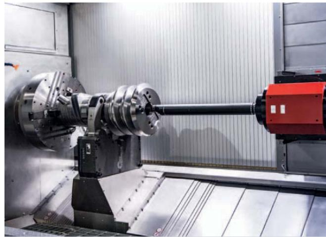
**Bohrstange:** Schwingungsgedämpfte Bohrstange mit einem Durchmesser von 100 x 1000 mm für Innendrehbearbeitungen. Es stehen drei extra dimensionierte Werkzeuge zur Verfügung.
