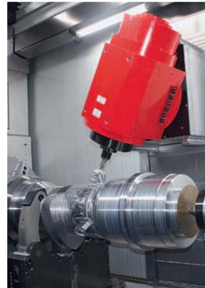
Frässpindel. In optionaler Ausführung mit 10.000 U/min. Hohe Geschwindigkeit für Dreh-, Bohr- und Fräsoperationen sowie Technologien in Leichtmetalllegierungen, Aluminium u.v.m. Der wassergekühlte ISM (integrierte Spindelmotor) ist bis 80 kW und 340 Nm Drehmoment und mit HSK-A 100 oder PSC80 (Capto C8) lieferbar.
