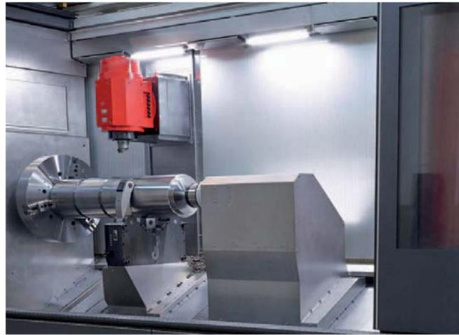
**Hauptspindel.** Für Dreh- und Fräsoperationen, ausgestattet mit 84 kW und 6400 Nm Drehmoment. Sperrluft, Spülung und programmierbarer Spanndruck sind Standard-Eigenschaften bei der Hyperturn 200. Eine oder mehrere programmierbare NC-Lünetten können die Bearbeitung unterstützen.
