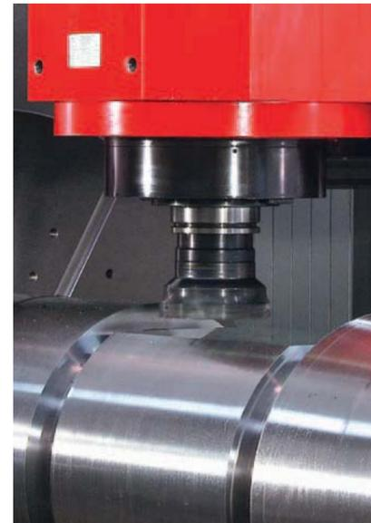
Frässpindel. In der Standard-Ausführung mit 6.500 U/min für alle Dreh-, Bohr- und Fräsoperationen und Technologien einsetzbar. Der wassergekühlte ISM (integrierte Spindelmotor) ist bis 80 kW und 630 Nm Drehmoment und mit HSK-A 100 oder PSC80 (Capto C8) lieferbar.
