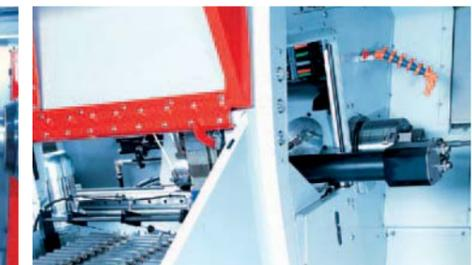
Vollautomatische Beladung von Wellen. Zuführung über Taktband, Abführung über die Fertigteilauflangvorrichtung.
