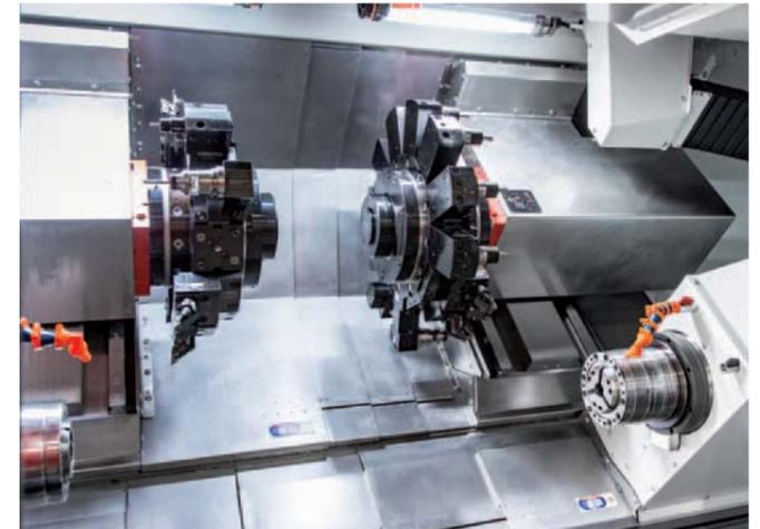
**BMT-Revolver.** Die stabile BMT-55P Schnittstelle ersetzt das VDI-Schnellwechselsystem. Damit können Kühlmitteldrücke bis zu 150 bar durch den Revolver umgesetzt werden. Weitere Vorteile liegen in der Wechselgenauigkeit und Stabilität der Schnittstelle.
