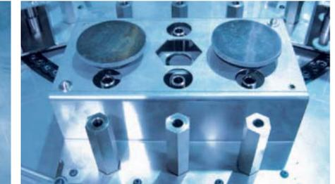
Mehrfach-Palettenaufsatz, ausgelegt für eine Teilefamilie
