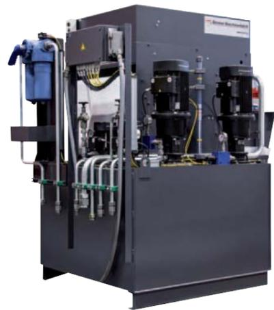
**Bandfilteranlage.** Für die Serienproduktion von Dreh/Fräsbauteilen aus Aluminium, Messing, Stahl oder Grauguss bietet sich eine Bandfilteranlage zur Kühlmittelaufbereitung an. Damit erhöht sich das Kühlmittelvolumen und auch die Lebensdauer des Kühlschmierstoffes.
