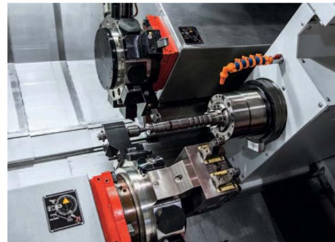
**Rollkörner/Revolverlunette.** Für die Komplettbearbeitung von Wellen einerseits in der Hauptspindel und andererseits in der Gegenspindel, stehen am Revolver ein Rollkörner und bei Bedarf auch eine Revolverlunette zur Verfügung. Damit lassen sich lange, schlanke Werkstücke präzise und ohne Rattermarken fertigen.
