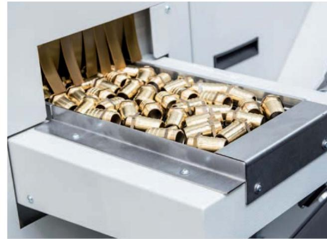
**Fertigteilstauband.** Auf dem innerhalb der Maschinenverkleidung, der Länge nach angeordnetem Stauband, mit einer Ablagefläche von 1400 x 180 mm werden die Werkstücke beschädigungsfrei abgelegt.
