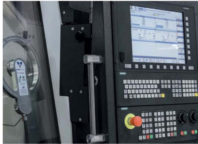
**Steuerung.** Die Sinumerik 840D sl mit Operate-Bedieneroberfläche ist ergonomisch rechts vom Arbeitsraum angeordnet, kann 80° geschwenkt und 100 mm in der Höhe verstellt werden. Bei den 1300er Versionen kann sie zusätzlich noch seitlich verschoben werden. An der Unterseite befindet sich eine 230 Volt Steckdose, die für etwaige Elektrogeräte verwendet werden kann.
