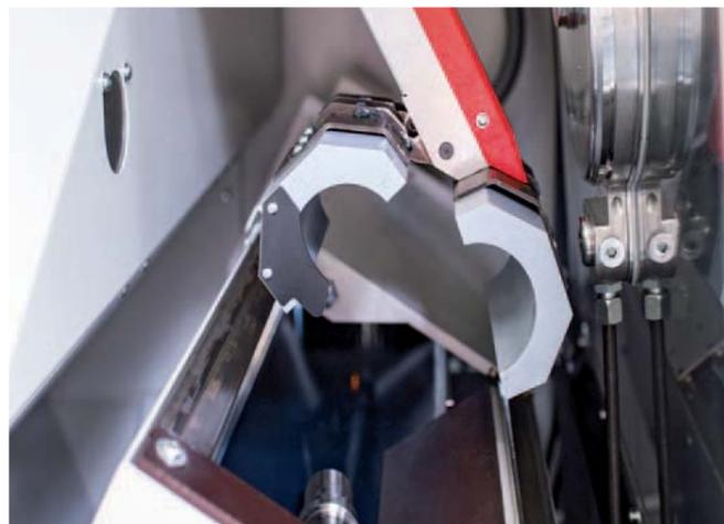
**Teilefänger.** Der elektro-pneumatische Teilefänger in der HYPERTURN 65 wird über M-Funktionen angesteuert. Bei Bedarf fährt er in den Arbeitsbereich vor und schwenkt zur Spindelmitte. Das Fertigteil wird aus dem Spannmittel gestoßen und gelangt in die Auffangschale. Danach fährt der Teilefänger wieder in die Grundstellung, wo das Teil auf ein Staubband abgelegt wird.
