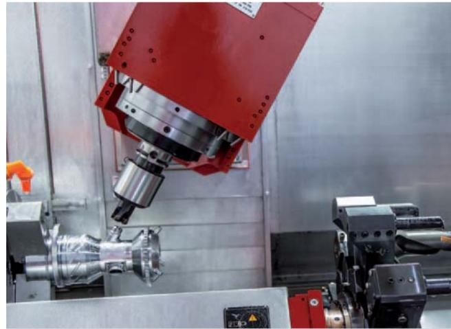
**Frässpindel.** Mit 29 kW / 79 Nm und einer max. Drehzahl von 12000 (18000) U/min können in der HYPERTURN 65 Powermill modernste Fräsverfahren wie HSC oder HPC umgesetzt werden. So lassen sich komplexe Dreh- und Frästeile äußerst effizient herstellen.
