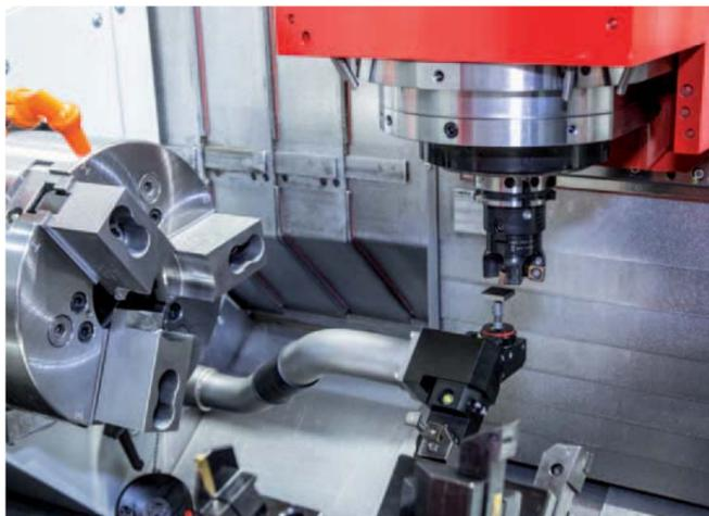
**Werkzeugvermessung.** Der Werkzeugmesstaster im Arbeitsraum ermöglicht das schnelle und präzise Vermessen der Werkzeuge im Arbeitsraum. Er wird händisch in die Aufnahme unterhalb der Hauptspindel montiert und nach Gebrauch wieder in eine Ablage abgelegt.
