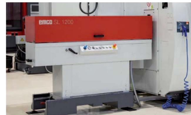
**EMCO Kurzlader.** Um dem immer größer werdenden Druck in Bezug auf Maschinenaufstellflächen gerecht zu werden, hat EMCO den kompaktesten am Markt erhältlichen Kurzlader entwickelt: den EMCO SL1200.
