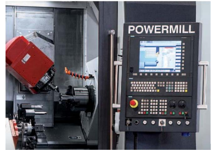
**Steuerung.** Die Steuerung Sinumerik 840D sl ist bei der HYPERTURN 65 PowerMill rechts vom Arbeitsraum, schwenkbar in einem verschiebbaren Panel, angeordnet. Damit wird ein Höchstmaß an Ergonomie für das Rüsten und Einfahren der Maschine garantiert.
