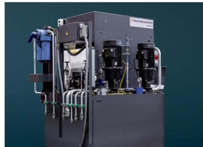
**Bandfilteranlage.** Für die Serienproduktion von Dreh/Fräsbau teilen aus Aluminium, Messing, Stahl oder Grauguss bietet sich eine Bandfilteranlage zur Kühlmittelaufbereitung an. Damit erhöht sich das Kühlmittelvolumen und auch die Lebensdauer des Kühlschmierstoffes. Kühlmittel drücke von 40, 60 oder 80 bar können realisiert werden.
