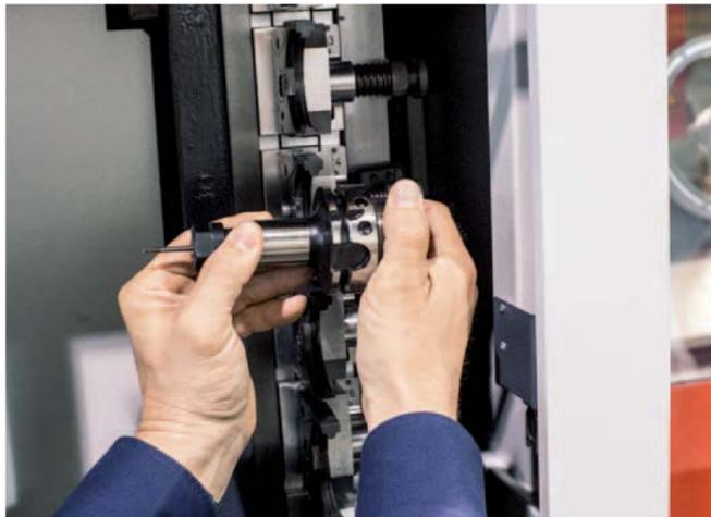
**Manuelle Werkzeugbestückung.** Die Werkzeuge können von vorne in die Werkzeugmagazine bestückt werden. Damit muss der Bediener nicht mehr zur Rückseite der Maschine gehen. Auch die Begutachtung des Werkzeugverschleißes bzw. -bruchs kann zeitsparend durchgeführt werden.
