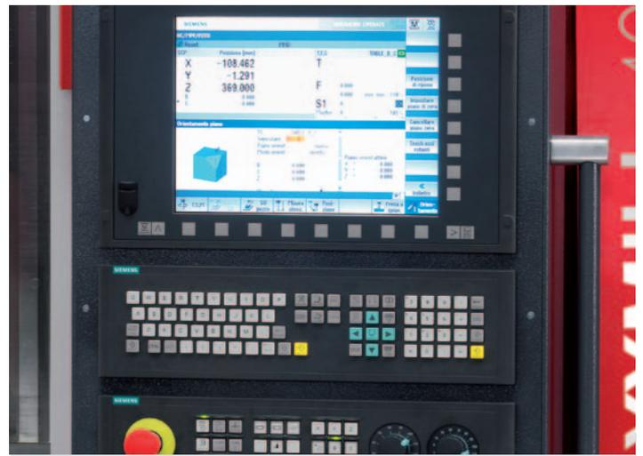
**Sinumerik 840D sl inkl. Shopmil.** Die Sinumerik 840D sl inkl. Shopmil ist das universelle und flexible CNC-System und bietet freie Konturprogrammierung, Fräszyklen für komplexe Konturen, schnelles Bezugspunkt-Setzen mit Tastsystemen, Schwenken der Bearbeitungsebene, Zylindermantel-Bearbeitung, 3D-Werkzeugkorrektur, schnelles Arbeiten durch kurze Satzverarbeitungszeit.
