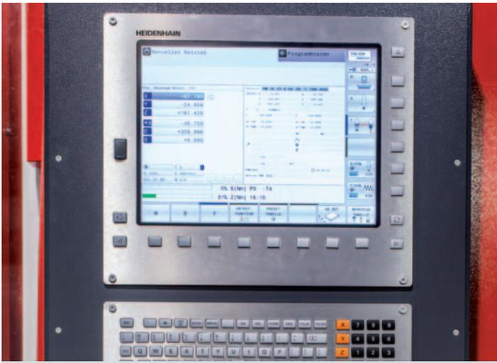
**Heidenhain TNC 620.** Die topaktuelle Steuerung ermöglicht neben Fräsbearbeitungen auch kombinierte Fräs-Dreh-Bearbeitungen. Sie eignet sich besonders für Fräs-Dreh-, HSC- und 5-Achs-Bearbeitungen an Maschinen mit bis zu 18 Achsen (nur für die Torque-Version möglich).
