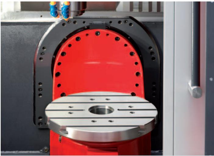
**Schwenkrundtisch.** Der Schwenkrundtisch hat eine flexible Aufspannfläche mit einem Durchmesser von 400 mm und kann mit 80 kg belastet werden. Ein Werkstück mit einer maximalen Kantenlänge von 250 x 250 x 225 mm kann auf 5 Seiten optimal bearbeitet werden.
