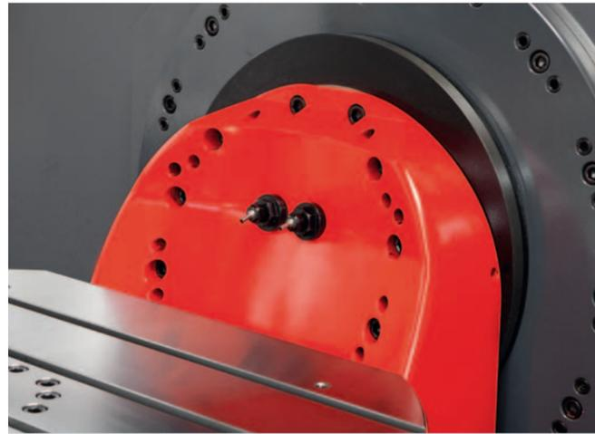
**Tischspülsystem:** 2 Düsen für die automatische Späne-Spülung des Tisches und Werkstückes, während der Bearbeitung auf jeder Tischposition.
