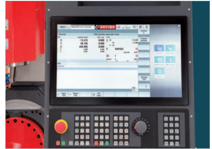
**Sinumerik 840D sl inkl. Shopmill.** Die Sinumerik 840D sl inkl. Shopmill ist das universelle und flexible CNC-System und bietet freie Konturprogrammierung, Fräszyklen für komplexe Konturen, schnelles Bezugspunkt-Setzen mit Tastsystemen, Schwenken der Bearbeitungsebene, Zylindermantel-Bearbeitung, 3D-Werkzeugkorrektur, schnelles Arbeiten durch kurze Satzverarbeitungszeit.
