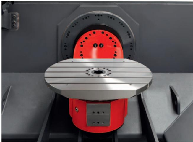
**Schwenkrundtisch.** Der Dreh-Schwenktisch hat eine großzügige Aufspannfläche von 750 x 600 mm und kann mit 300 kg belastet werden. Ein Werkstück mit einer Kantenlänge von 530 x 530 x 417 mm kann daher problemlos bearbeitet werden. Die besondere Form des Tisches ermöglicht, dass die Spindelnase näher zum Tischzentrum gelangen kann.
