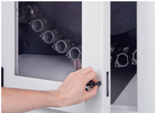
**Werkzeugmagazin.** Ausgestattet mit 30 Werkzeugplätzen. Ein Werkzeugmagazin mit 40 oder 60 Werkzeugstationen ist als Option verfügbar. Die Werkzeugverwaltung basiert auf dem Prinzip der variablen Werkzeugplatzkodierung (random), d.h. das Werkzeug wird aus Zeitgründen immer im nächsten freien Magazinplatz abgelegt. Die Werkzeugmagazintür erlaubt die schnelle Beladung des Werkzeugs.
