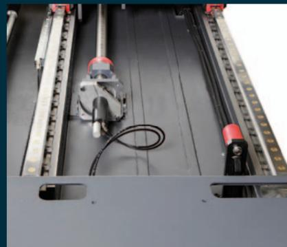
**Achsantriebe.** Die Linearachsen besitzen Linearführungen. Um die notwendige Stabilität zu erreichen, werden lange Führungsschuhe verwendet. Der Antrieb erfolgt über Kugelgewindetriebe, die direkt über Balgkupplungen angetrieben werden. Der Direktantrieb ermöglicht eine hohe Dynamik der Achsen und gleichzeitig kommt hier ein wartungsarmes und ruhiges Antriebssystem zum Einsatz. Aufgrund des langen Verfahrweges ist der Linearmaßstab in der X-Achse Standard.
