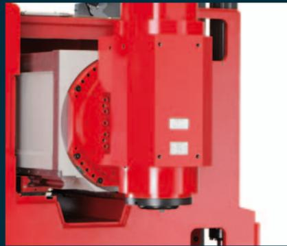
**Frässpindel.** Die Maschine ist mit einer flüssigkeitsgekühlten Motorspindel mit überzeugenden Leistungsdaten ausgestattet. Mit einer Spindel-drehzahl von 15.000 U/min, einer Leistung von 46 kW und einem Drehmoment von 170 Nm ist die Maschine auch für schwere Zerspanung geeignet. Motorspindel nun auch mit 18000 U/min (nur HSK A63 Version) verfügbar.
