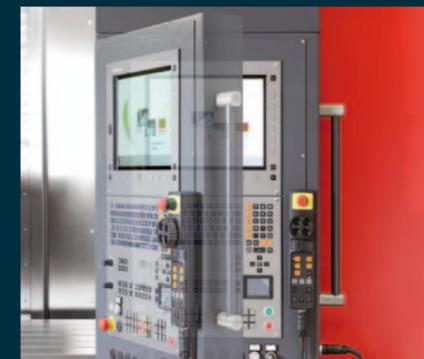
**Steuerung.** Das Bedienpult ist verfahrbar und in Richtung Arbeitsraum schwenkbar. Dieser ergonomische Aufbau schafft für den Bediener optimale Arbeitsbedingungen.
