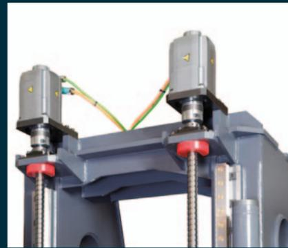
**Vorschub in der Z-Achse.** Um mit der Z-Achse schnell - nämlich mit 50 m/min - und präzise verfahren zu können wird diese Achse, aufgrund des hohen Gewichts, von zwei Kugelgewindetrieben und zwei Motoren im Master-Slave-Betrieb angetrieben.
