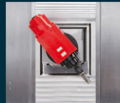
**B-Achse:** Die B-Achse wird von einem Torquemotor angetrieben und erreicht eine hohe Dynamik innerhalb des Schwenkbereichs von +/- 120 Grad.
