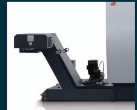
**Scharnierbandförderer:** Die Späne werden durch die Spänespülung in den Scharnierbandförderer gewaschen und von diesem automatisch aus der Maschine in einen vom Kunden bereitgestellten Behälter transportiert.
