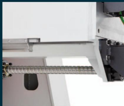
**Y-Achse:** Die Y-Achse ist als „Ram“ ausgeführt. Hier werden lange Führungsschuhe verwendet, um die notwendige Stabilität zu erreichen. Die hohe Präzision wird durch den Direktantriebsmotor an der Spindel garantiert.
