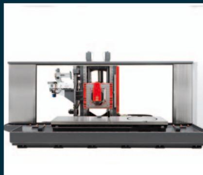
**Maschinenbett:** Das Maschinenbett ist ein Polymerbetonbett. Dadurch wird die notwendige Stabilität der Maschinenbasis und auch die Schwingungsdämpfung optimal gewährleistet.
