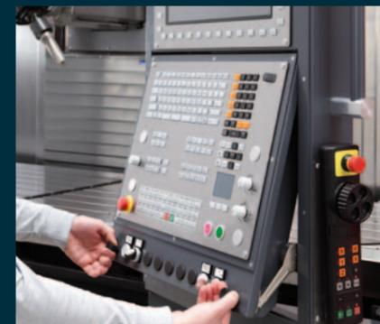
**Steuerung:** Das Bedienpult kann in Richtung des Arbeitsbereichs verfahren, gedreht und angepasst werden. Dieses ergonomische Design schafft ideale Arbeitsbedingungen für den Bediener.
