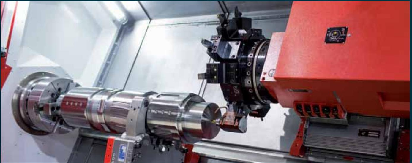
Die Maxxturn Serie ist in einem modularen Baukastensystem mit Ausbaustufen vom einfachen Drehen bis zum Dreh-Fräszentrum mit vielfältigem Anwendungsmöglichkeiten aufgebaut: dynamisch integrierter Spindelmotor ebenso wie hohe Drehmoment-Umsetzungen, Direct Drive Revolver mit BMT oder VDI-Haltersysteme.
