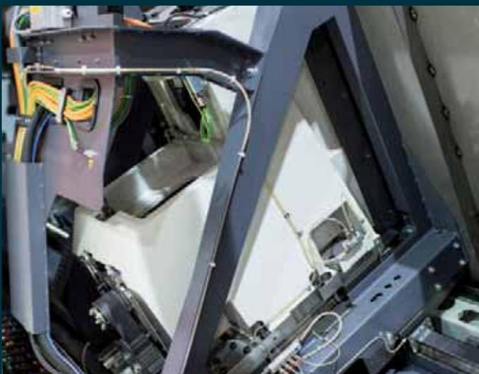
**Hochpräzise Y-Achsen:** Das Maxxturn Maschinenkonzept wurde speziell so entwickelt, dass die Y-Achse in einem Winkel von 90° aufgesetzt ist. Diese Y-Achse bietet durch breit aufgesetzte und bereits vorgespannte, sowie großdimensionierte Führungsbahnen optimale Bearbeitungsergebnisse bei höchster Stabilität mit kurzen Auskräglängen.
