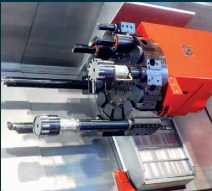
**Bearbeitungsmöglichkeiten:** Auf der MT110 mit VDI50 und Block-tools können mit Hilfe von Rollierwerkzeugen prozessoptimierte, kurze Zylinderrohrbearbeitungen mit einer Oberflächenqualität von RA 0,2 durchgeführt werden. Mit der 80 bar Bandfilteranlage/Kühlmittelvorbereitung erhöht sich das Kühlmittelvolumen sowie die Qualität und Lebensdauer des Kühlschmierstoffes.
