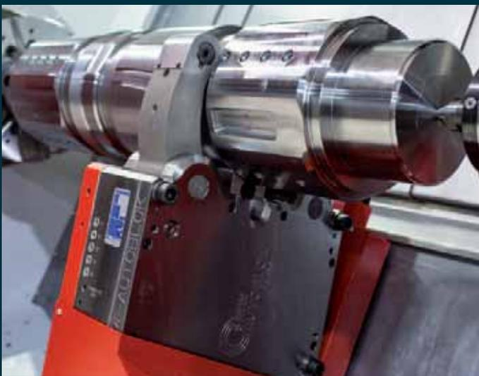
**Automatische Lünetten:** Selbstzentrierende Lünette mit hydraulischer Betätigung. Aufgebaut auf der Führungsbahn des Reitstockes und über Z-Schlitten schleppbar. Optional auch mit Servoantrieb verfahrbar (NC-Achse). Sperrluft, Zentralschmierung, Spülung sowie integrierte Spülkanäle an den Armen (optional) für eine oder mehrere Lünetteneinheiten oder Schlittensysteme verfügbar.
