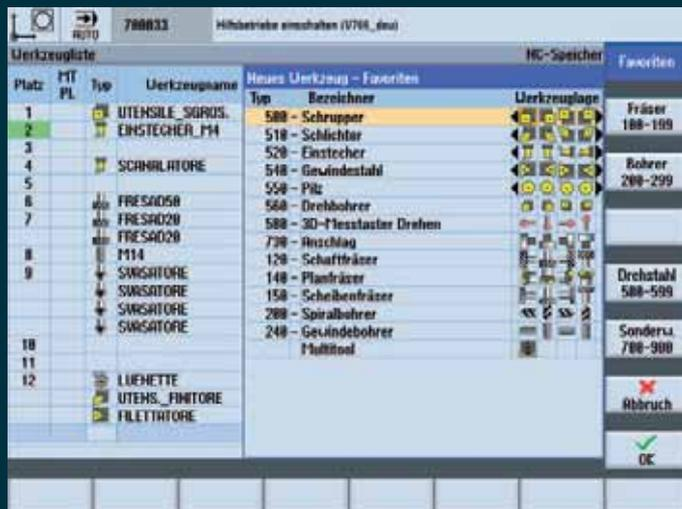
**Werkzeugmanagement:** Einfache und offene Bedienung mittels integrierter Werkzeugverwaltung für alle Werkzeug-Typen und -Daten.
