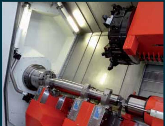
**Lünetten / Spanssituation:** Hochpräzise Komplettbearbeitung ist mit 3 Lünetten auf zwei prozessgesteuerten Schlitten möglich. Wellenspannfutter mit rückziehbarem Backenträger und Stirnmitnehmer sowie Werkzeugvermessung für optimale Produktivität bei gleichzeitig maximaler Flexibilität.
