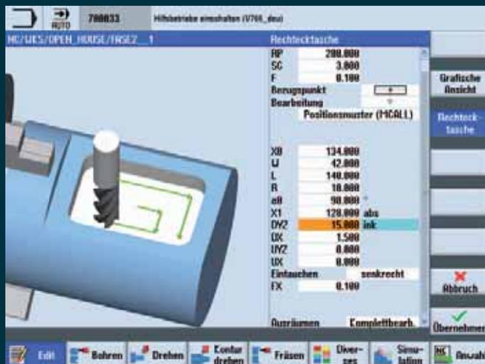
**Shopturn-Shopmill /Bearbeitungszyklen:** Die Maschinen Programmierung kann von DIN- bis Shopturn komplett frei gewählt werden. Komplexe Werkstücke erfordern wirtschaftliche Fertigungsmethoden und innovative CNC-Lösungen. Die CNC-Ausrüstung SINUMERIK 840D sl unterstützt Multitechnologiemaschinen bei der Bearbeitung von Werkstücken in einer Aufspannung und bietet hierfür innovative Funktionalitäten – auch im Wechsel zwischen unterschiedlichen Technologien.
