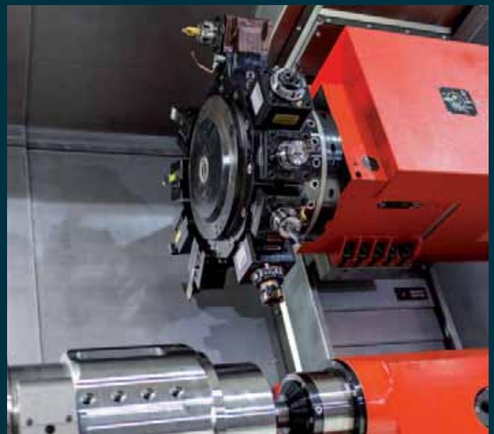
**MT 110 BMT-Revolver.** Zur wirtschaftlichen Fertigung von aufwendigen Dreh- / Fräswerkstücken mit überwiegendem Fräsanteil, gibt es optional den BMT 65P-Revolver mit wassergekühltem Direktantrieb. Mit max. 9600 U/min, 56 Nm und 17,6 kW bietet dieser Revolver optimale Voraussetzungen, Stabilität für die Komplettbearbeitung und maximale Produktivität.
