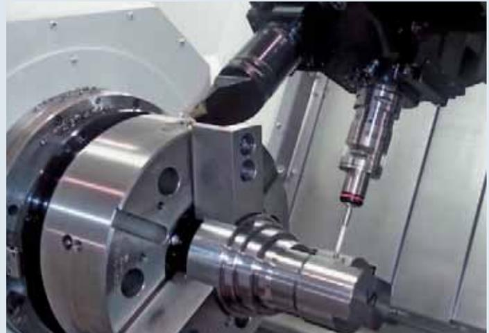
Der Messstaster wird im Revolver mit Funk-Übertragung zum Abtasten der Werkstücke und automatischer Übernahme der Werte mittels Messzyklen eingesetzt.
