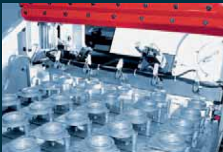
Taktförderband für die orientierte Rohteilzuführung mit großem Teilevorlauf
