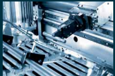
Taktförderband mit Prismenauflagen für unterschiedlich vorgeformte Wellenteile
