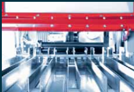
Mehrbahnige Zuführrinne für rotationssymmetrische Rohteile; die Rohteillänge bestimmt die Anzahl der Zuführinnen
