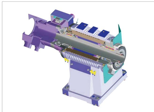
**Integrierte Spindelmotoren (ISM).** Modernste Sychrontechnik garantiert höchste Dynamik und ein außergewöhnliches Drehmoment bei kompakter Bauweise. Eine Flüssigkeitskühlung in Verbindung mit einer automatischen Temperaturregelung sorgt für eine konstante Temperatur sämtlicher Spindelmotoren.
