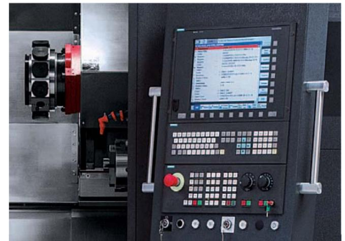
**Steuerung.** Die Sinumerik 840D sl mit Operate-Bedieneroberfläche bzw. Fanuc 31i inklusive Manual Guide i ist ergonomisch rechts vom Arbeitsraum angeordnet und kann ca. 80° geschwenkt werden. Je nach Kundenwunsch gibt es anstatt des 10,4"-Monitor auch einen 15"-Monitor samt 100 mm Höhenverstellung und einer 230 Volt-Steckdose an der Unterseite, die für etwaige Elektrogeräte verwendet werden kann.
