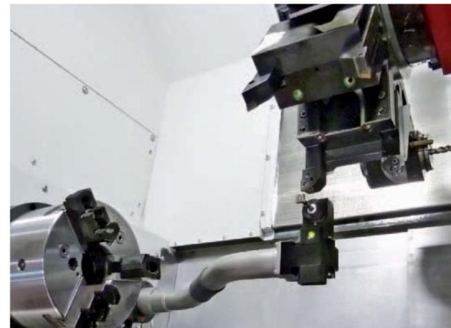
**Werkzeugvermessung.** Der Werkzeugmesstaster im Arbeitsraum ermöglicht das schnelle und präzise Vermessen der Werkzeuge im Arbeitsraum. Er wird händisch in die Aufnahme unterhalb der Hauptspindel montiert und nach Gebrauch wieder in eine Ablage an der linken Maschinenverkleidung abgelegt.
