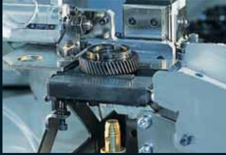
**Messeinrichtung:** Am Magazintisch integrierte Messstation für die mannarme Fertigung von Präzisionsteilen. Die Werkzeugkorrekturen werden vollautomatisch nachjustiert. Jedes Werkstück wird mit dem Portallader in die Messeinrichtung gelegt und mit dem Messdorn vermessen. Gut-Teile werden in den Teilebehälter gestoßen, Ausschussteile werden gesondert abgelegt.
