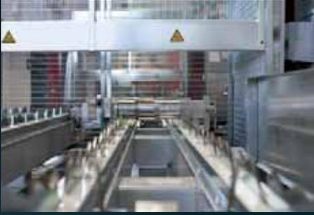
**Magazinierung:** Die Roh- und Fertigteile werden mit einem 2-spurigem Taktband automatisch zu- bzw. abgeführt. Das Band wurde für eine Kapazität von 20 Teilen ausgelegt. Der Wellengreifer greift das beidseitig zentrierte Rohteil vom Taktband ab und bringt dieses in die Maschine. Die Magazinierung der Roh- und Fertigteile erfolgt identisch. Das Beladeportal ist für ein max. Werkstückgewicht von 150 kg ausgelegt.
