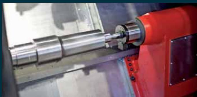
**Reitstock.** Der Reitstock sitzt auf einer Wälzföhrung und kann serienmäßig über den Werkzeugschlitten geschleppt und positioniert werden. Bei Bedarf kann ein Kugelgewindetrieb die Verfahrensbewegung übernehmen. In der jeweiligen Position wird er über eine Klemmvorrichtung hydraulisch geklemmt. Eine Pinole mit integrierter Lagerung und MK4-Aufnahme übernimmt dann mit einem max. Hub von 120 mm die Abstützung des Werkstückes.
