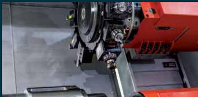
**BMT-Revolver.** Zur wirtschaftlichen Fertigung von aufwendigen Dreh- / Fräswerkstücken mit überwiegender Fräsanteil, gibt es optional den BMT 55P-Revolver mit wassergekühltem Direktantrieb. Mit max. 12000 U/min, 30 Nm und 10 kW bietet dieser Revolver optimale Voraussetzungen für die Komplettbearbeitung.
