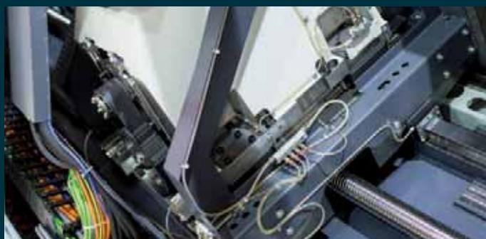
**Y-Achse.** Die Y-Achse bildet ein Highlight in der MAXXTURN Serie. Sie ist im Maschinenaufbau so integriert, dass höchstmögliche Stabilität anhand von kurzen Auskräglängen und breiten Führungsbahnabständen garantiert wird. Damit lassen sich komplexe Bearbeitungsaufgaben durchführen und Werkstücke in nur einer Aufspannung komplett herstellen. Eine Vielzahl von Bearbeitungszyklen in der Steuerung erlauben eine einfache Programmierung und Anwendung der zusätzlichen Linearachse.
