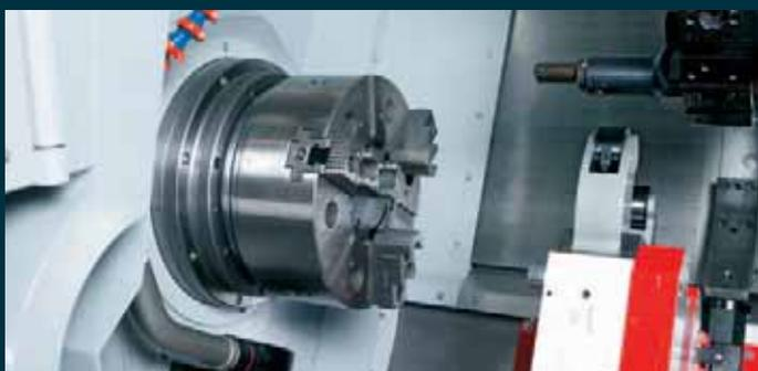
**Hauptspindel.** Es stehen zwei Varianten zur Auswahl. Einmal die Spindel mit konventionellem Riemenantrieb für hohe Zerspanungsmomente (bis 1040 Nm) und einmal die bewährte wassergekühlte Motorspindel für hohe Drehzahlen. Diese bietet auch optimale Voraussetzungen für komplexe Fräsbearbeitungen.
