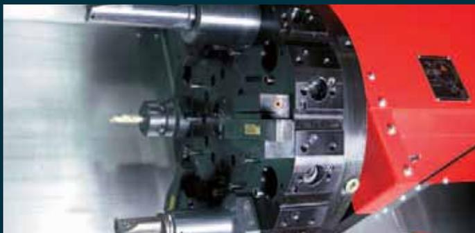
**Werkzeugrevolver.** 12-fach VDI 40 Axialrevolver mit Ein-Motoren-Technik. Ein Servomotor treibt die angetriebenen Werkzeuge und die Schwenkbewegung. Kein Abheben, durchschaltend mit Richtungslogik. Jede Station kann angetriebene Werkzeughalter mit Kupplung DIN 5480 aufnehmen. Zusätzlich befinden sich am Umfang 12 Blocktool-Aufnahmen. Diese ermöglichen die Aufnahme von schweren Bohrstangen bis Durchmesser 50 mm.
