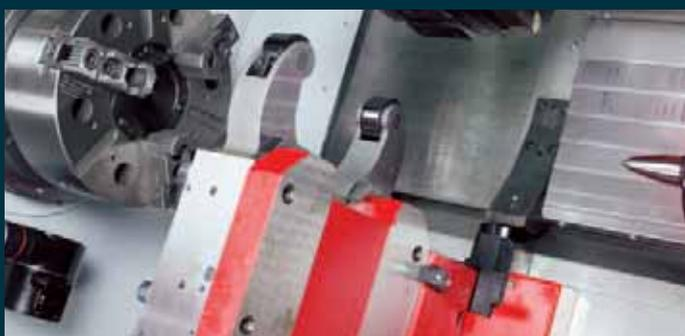
**Lünette.** Die hydraulisch betätigte Lünette mit einem Zentrierbereich von  $\varnothing$  30 – 245 mm sitzt auf einem Schiebeshlitten der entweder über den Werkzeugschlitten geschleppt und positioniert wird oder optional über einen eigenständigen Kugelgewindetrieb verfahren werden kann. In Position wird er über eine Klemmvorrichtung hydraulisch geklemmt. Die Lünette ist mit Späneschutz ausgestattet und an die Zentralschmierung angeschlossen.
