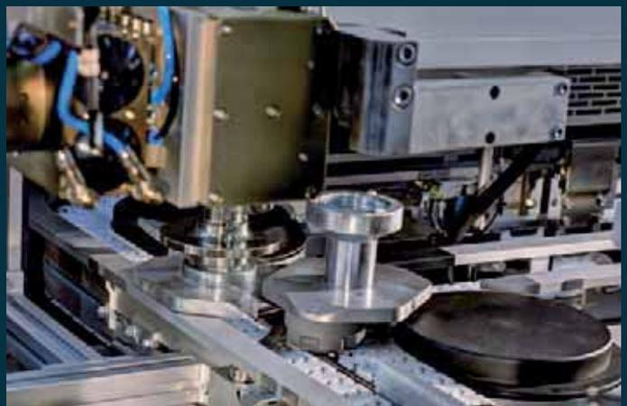
180° Wendestation, Wendevorgang abgeschlossen. Werkstückträger für Op 10 ohne Werkstück fährt über Weiche zurück zum Beladen der Rohteile. Werkstückträger für Op 20 mit Werkstück fährt zur Bearbeitung der 2. Operation.
