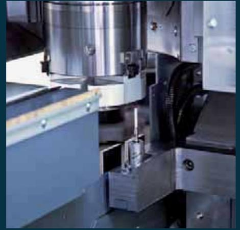
Integrierte Werkstückvermessung: Im Übergangsbereich von Arbeitsraum zur Beladeposition kann das Werkstück mit einem Messtaster vermessen werden. Der Messtaster wird während der Bearbeitung im Arbeitsraum durch eine Abdeckung vor Späneflug und Kühlmittel geschützt.
