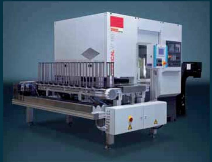
Stapelbare Werkstückmagazine für Großserienfertigung sind neben Schlepprahmen und Paletten-Systemen eine bevorzugte Lösung bei Vertikalmaschinen. Dieses Magazin mit 10 einzelnen Stapelmagazinen ist für ringförmige Teile wie z.B. Kupplungsscheiben, Synchronringe, etc. besonders geeignet. Pro Magazinschacht sind hier bis zu 60 Teile stapelbar. 600 Teile werden hier der VT 160 Vertikalmaschine zugeführt.
