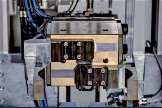
Die Maschine ist mit einem 180° Werkstückwender und Hubstation (Hubhöhe 300 mm) ausgestattet. Diese ist wahlweise pneumatisch mit Festanschlag oder elektrisch als NC-Achse betätigt. Der Greiferhub ist für Durchmesser bis 220 mm konzipiert. Die Schwenkeinheit besitzt einen Pneumatiktrieb.
