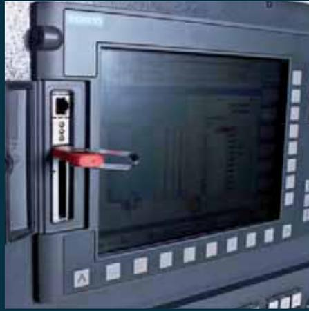
Die topaktuelle Siemens 828D-Steuerung beinhaltet die neuesten Funktionen der Siemens Oberfläche „Operate“. Basierend auf der „Solution Line Technologie“ bietet diese Steuerung eine ideale Lösung für 1-Kanal Maschinen wie etwa die VT 400, VT 260 oder die VT 160. Die Kommunikation ist über die gebräuchlichsten Schnittstellen wie USB-, CF-Karte und Ethernet an der Vorderseite der Steuerung möglich.
