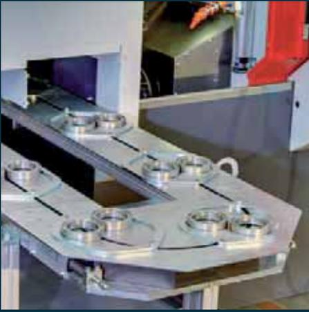
VT 160 mit Zwei-Spurbeladung. Bis zu einem Teiledurchmesser von 100 mm kann mit der Zwei-Spurbeladung bearbeitet werden.
