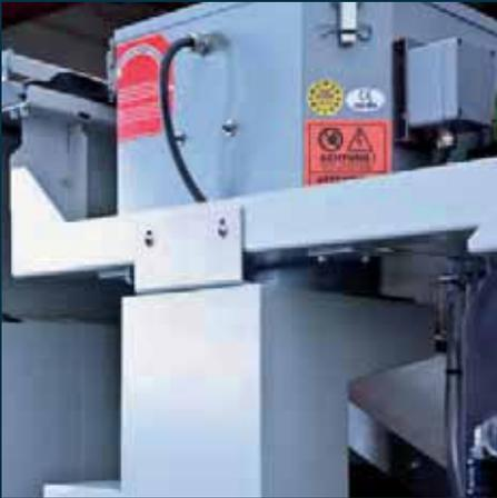
Der komplett geschlossene Arbeitsraum macht optional den Einbau einer Absaugvorrichtung möglich. Mit diesen Maßnahmen wird die Maschine im Betrieb deutlich umweltfreundlicher. Die Öldämpfe werden aus dem Arbeitsraum gefiltert und nur saubere Luft entweicht aus den Maschinen.
