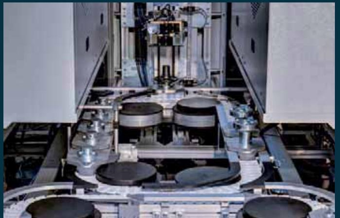
Eine integrierte Bypass-Linie ermöglicht sowohl eine gleichzeitige Fertigung unterschiedlicher Werkstücke, als auch eine unterschiedliche Spannung bei OP 10 und OP 20.
