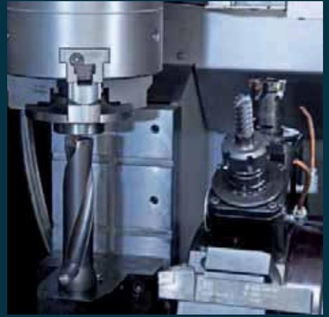
Sehr stabile Multifunktionsplatte. Bei der Version ohne Y-Achse auch für die Verwendung von langen Bohrwerkzeugen geeignet.
