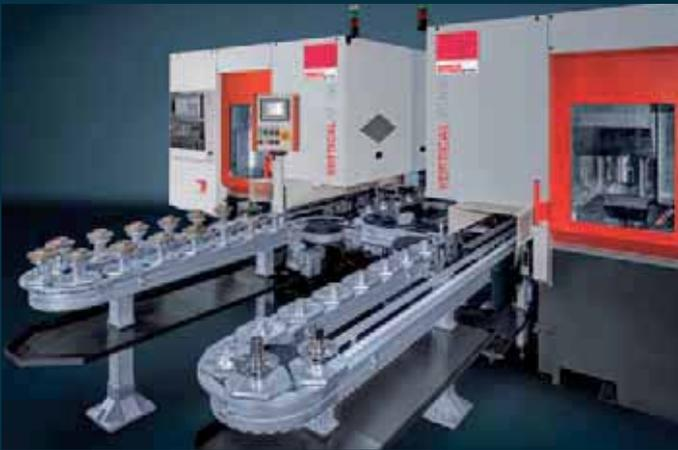
Die DUO VT gibt es in Mäanderausführung die mit einem 180°-Wender und optional mit Weiche ausgestattet ist. Je Operation ist ein Einsatz von 25 Paletten möglich. Für verschiedene Betriebsarten (Hand, Einrichten, Automatik) steht eine eigene Steuerung zur Verfügung.
