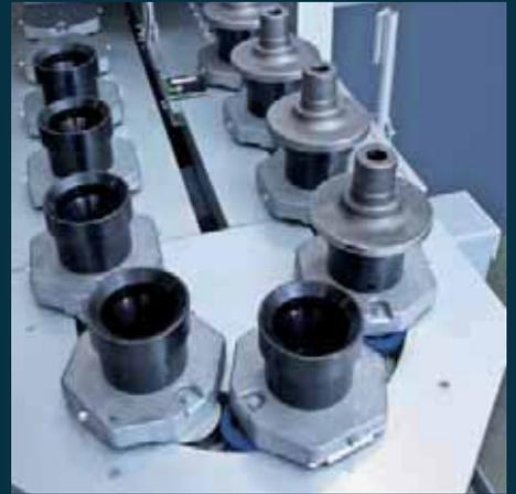
Die Maschinen können mit unterschiedlichen Förderbändern ausgestattet werden. Eine Möglichkeit etwa ist das Paletten Band-Standardverkehtungssystem mit gefederter Pick-Up-Station, inklusive 20 Werkstückträgern. Die Förderrichtung des Schleppriemenbandes ist im Uhrzeigersinn. Das Band steht in der Breite komplett unter der Maschine.
