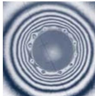
Lichtinterferenzbild eines Rockwelleindrucks
