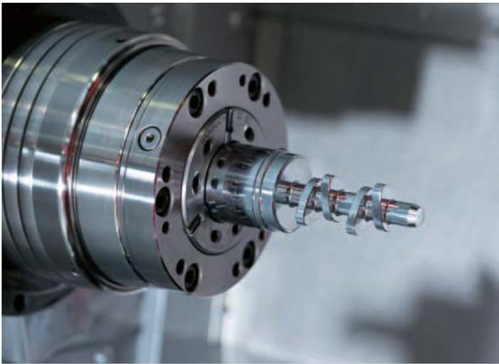
**Hauptspindel.** Die 15 kW Motorspindel sorgt mit integrierter Wasserkühlung für hohe Dynamik bei geringer thermischer Verlagerung. Ein hochauflösender Drehgeber bietet beste Voraussetzungen für die konturgenaue Fräs- und Bohrbearbeitung.
