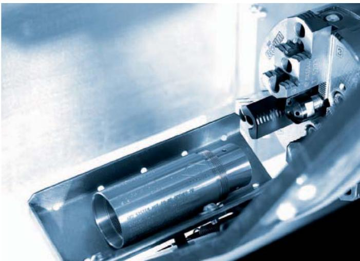
**Teilefänger.** Der pneumatisch betätigte Teilefänger in der HYPERTURN 45 wird über M-Funktionen angesteuert. Bei Bedarf fährt er in den Arbeitsbereich vor und schwenkt zur Spindelmitte. Das Fertigteil wird aus dem Spannmittel gestoßen und gelangt in die Auffangschale. Danach fährt der Teilefänger wieder in die Grundstellung, wo das Teil in eine Auffangbox oder auf ein Staubband gekippt wird.
