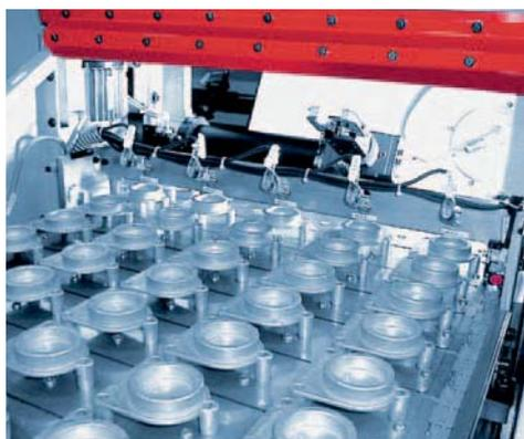
Taktförderband für die orientierte Rohteilzuführung mit großem Teilevorrat.
