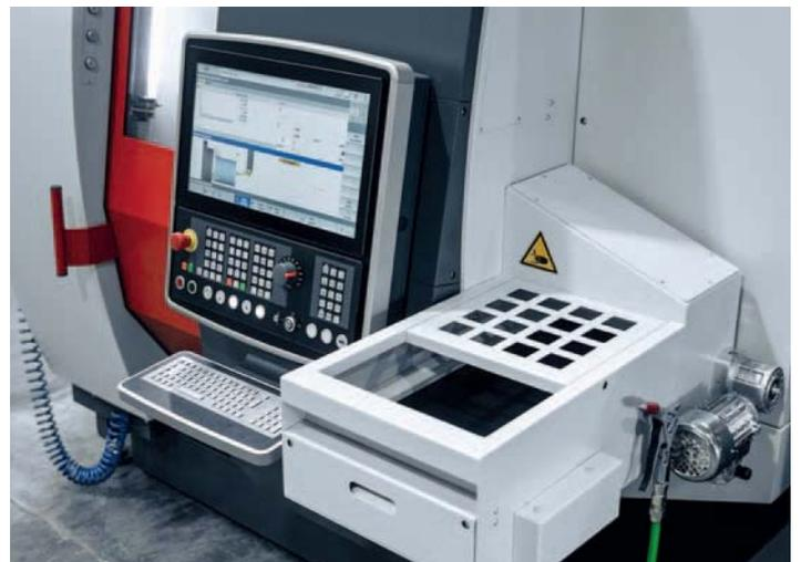
**Fertigteileband.** Mit dem Teilefänger werden die Fertigteile auf ein mit einer nutzbaren Ablagefläche von 340 x 750 mm. Ein Takten des Bandes verhindert, dass die zum Teil sehr komplexen Teile aufeinander fallen.
