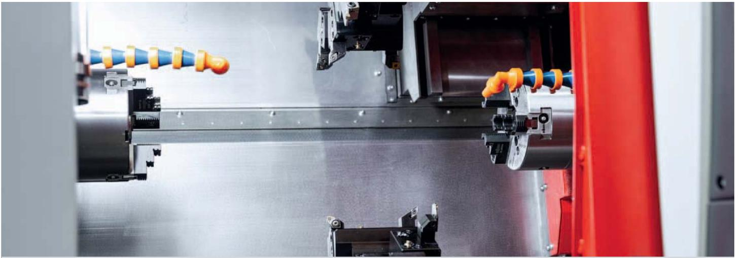
**Arbeitsraum.** Der großzügig gestaltete Arbeitsraum bietet Platz für viele Werkzeuge an beiden Revolvern und sorgt für kontinuierlichen Spänefluss auch bei mannarmer Fertigung. Zusätzliche Kühlmittelpumpen und ein ausgefeiltes Rohrsystem spülen die Späne in den Späneförderer.
