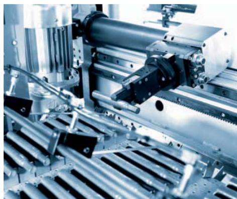
Taktförderband mit Prismenauflagen für unterschiedlich vorgeformte Wellenteile.
