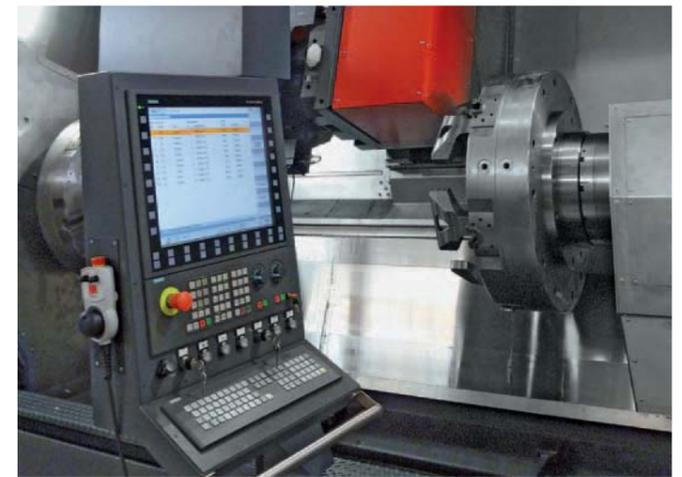
**Steuerung:** Die Maschine ist mit der Steuerung Siemens 840D sl ausgestattet. Zum Umfang gehören ein 22" Monitor mit neuester emcoNNECT Bedienoberfläche sowie vielfältige EMCO Technologie-Zyklen (optional) für einfaches, dialoggestütztes Programmieren.
