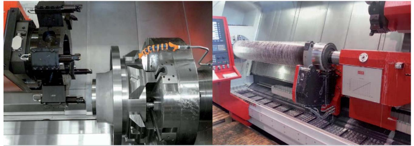
**Reitstock / Gegenspindel:** Die Maschine verfügt über einen NC-gesteuerten Reitstock (optional) mit integrierter Lagerung und MK6-Pinole für eine sichere und stabile Abstützung von Werkstücken bis zu einem maximalen Werkstückgewicht von 6 Tonnen. Mit der optional erhältlichen Gegenspindel können Werkstücke komplett in einem Arbeitsgang gefertigt bzw. zwei Werkstücke gleichzeitig bearbeitet werden.
