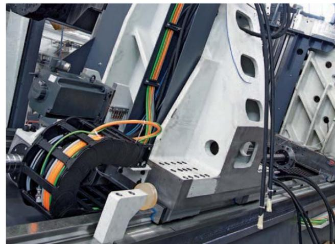
**Hochpräzise Y-Achsen:** Das Maxxturn Maschinenkonzept wurde speziell so entwickelt, dass die Y-Achse in einem Winkel von 90° aufgesetzt ist. Diese Y-Achse bietet durch breit aufgesetzte und bereits vorgespannte sowie großdimensionierte Führungsbahnen optimale Bearbeitungsergebnisse bei höchster Stabilität mit kurzen Auskraglängen; für bis zu zwei Revolver möglich.
