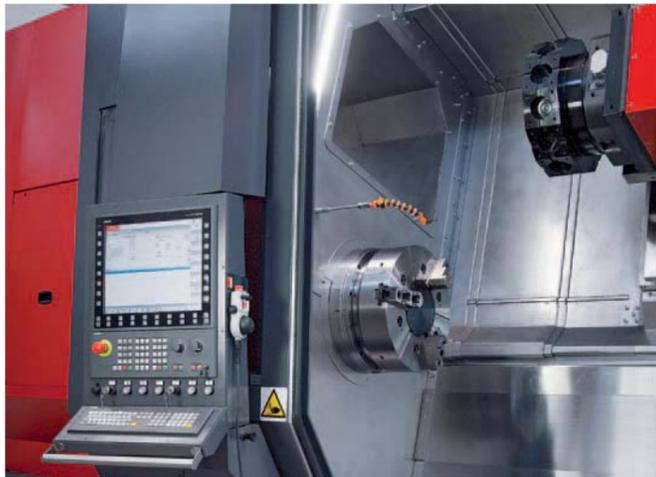
**Die Maxxturn 200** ist in einem modularen Baukastensystem mit Ausbaustufen vom einfachen Drehen bis zum Dreh-Fräszentrum mit vielfältigen Anwendungsmöglichkeiten aufgebaut. Dabei kommen verschiedene Spindelkonzepte mit C-Achse und hohem Drehmoment zum Einsatz.
